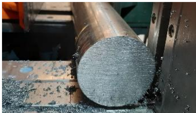
Ilustración 3-18: Varilla SAE 1020 de 30 cm
