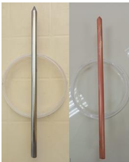
Ilustración 4-4: Varilla de acero de 30 cm antes y después del cobreado
