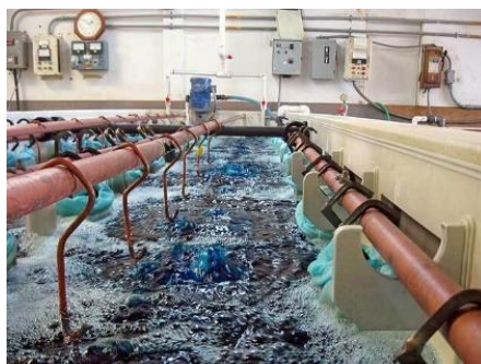
Ilustración 2-7: Proceso de Galvanoplastia
