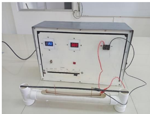
Ilustración 3-9: Armado e instalación del equipo de cobreado
