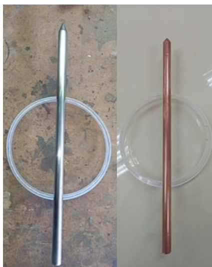
Ilustración 4-2: Varilla de acero de 30 cm antes y después del cobreado
