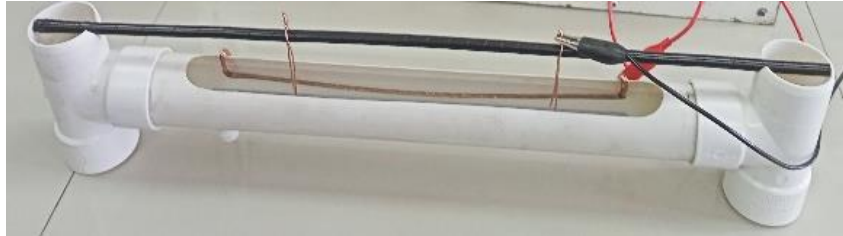
Ilustración 3-15: Cuba electrolítica PVC
