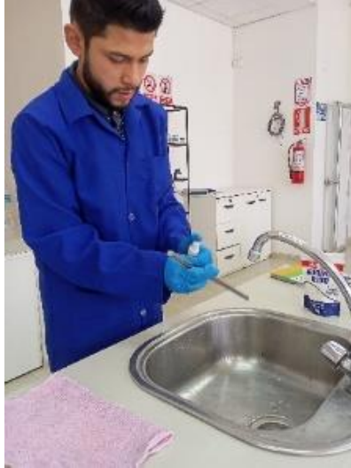
Ilustración 3-4: Desengrase de la varilla de acero
