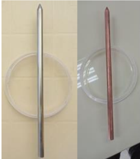
Ilustración 4-6: Varilla de acero de 30 cm antes y después del cobreado
