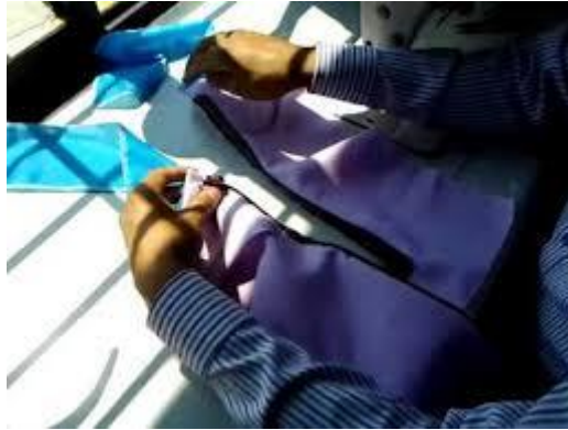
Ilustración 5-22: Colocación de cierres
