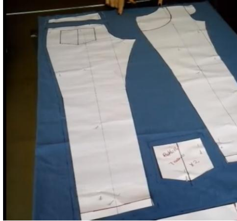
Ilustración 5-16: Colocación de moldes en la tela
