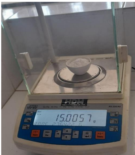
D1. Pesado de la alúmina para el catalizador Ni-Zn/Al 2 O 3
