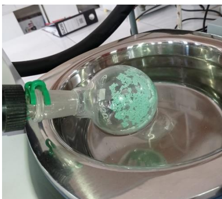
C5. Incorporación de nitrato de níquel hexahidratado en la alúmina
