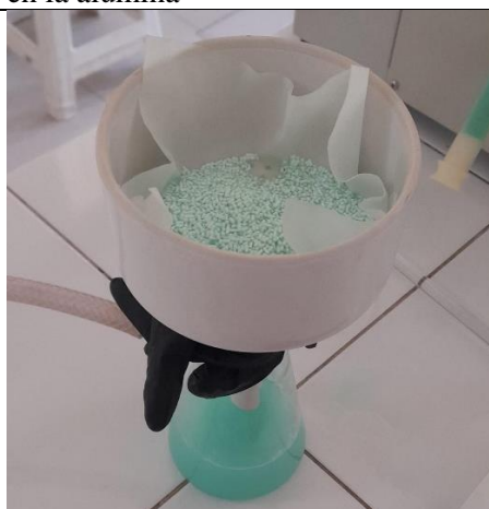
C6. Filtración al vacío
