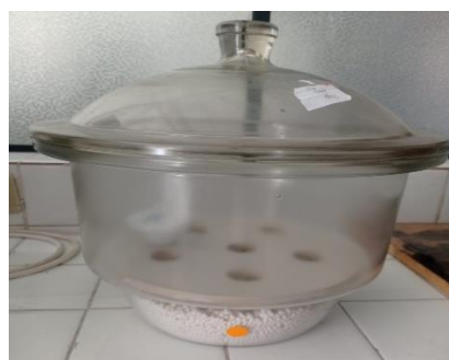
D8. Secado de la alúmina impregnada de níquel y zinc
