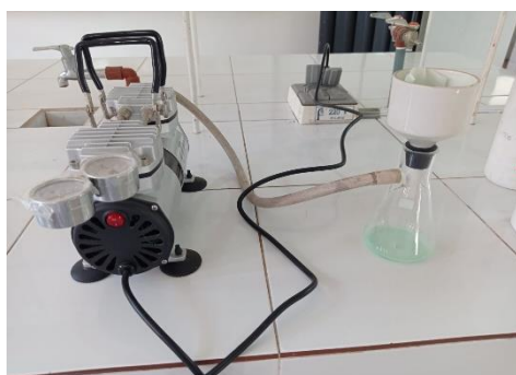
D7. Filtración al vacío
