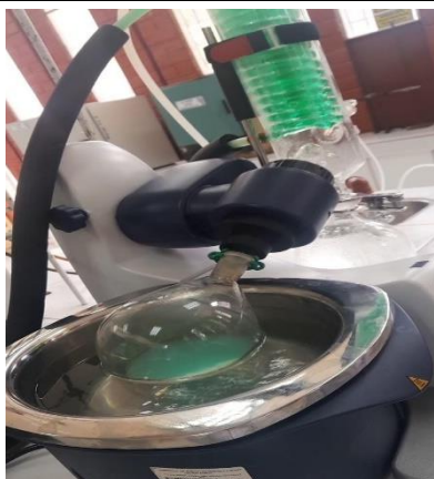
D5. Incorporación de nitrato de níquel hexahidratado en la alúmina
