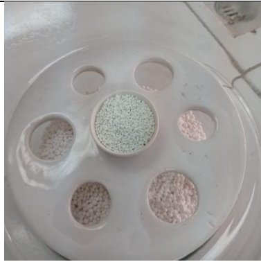
C6. Secado de la alúmina impregnada de níquel
