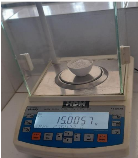
C1. Pesado de la alúmina para el catalizador Ni/Al 2 O 3
