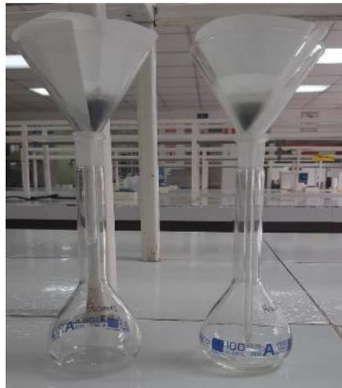
**Fotografía N°12.** Muestra de hueso y escamas aforadas para analizar
