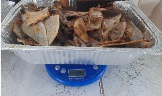
**Fotografía N°2.** Muestra de huesos de pescado posterior al análisis de humedad
