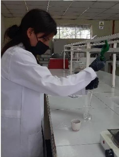
**Fotografía N°8.** Muestras de cenizas humedecidas (digestión ácida)
