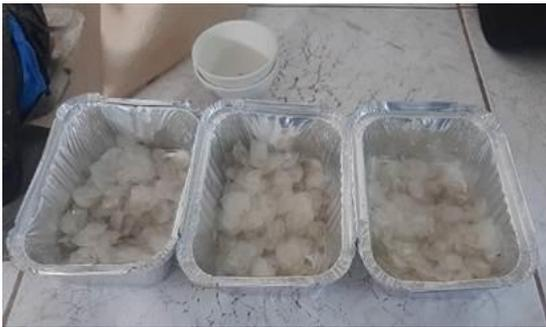
**Fotografía N°4.** Muestras de escamas de pescado posterior al análisis de humedad
