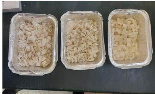
**Fotografía N°5.** Muestras de escamas de pescado posterior al análisis de cenizas
