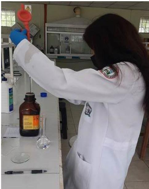
**Fotografía N°11.** Filtración de cenizas humedecidas con HCl para analizar
