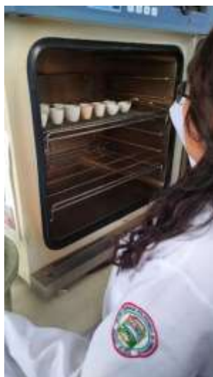
Ilustración 8-2. Análisis del porcentaje de materia orgánica y carbón orgánico en el laboratorio de Investigación y Desarrollo Ambiental y Cambio Climático
