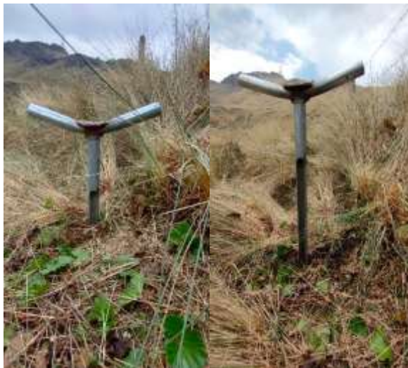
Ilustración 3-2. Recolección de muestras con barrenos
