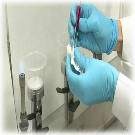
**C1:** Filtración por membrana de las muestras de las muestras de agua.
