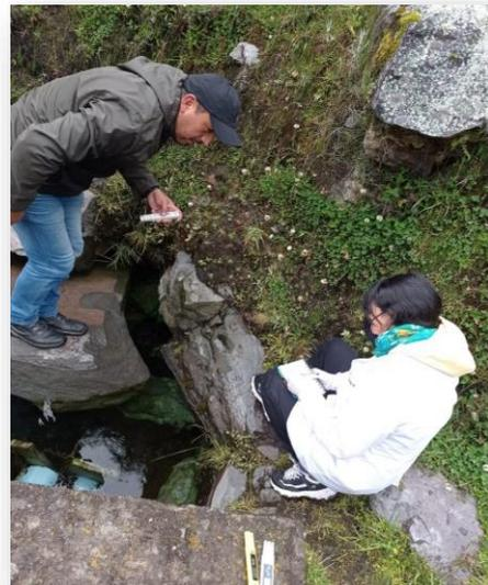
**A4.** Medición de ph, temperatura, TDS, conductividad eléctrica.
