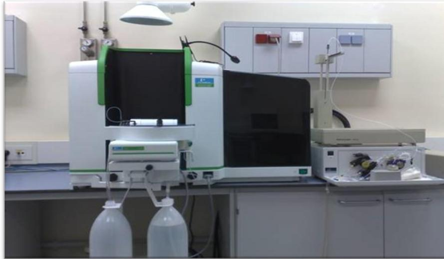
**Ilustración 3-15:** Equipo de Espectrofotómetro de Absorción Atómica.
