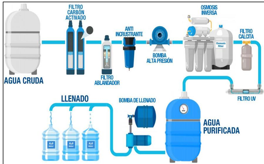
**Ilustración 2-3:** Proceso de purificación del agua mineral
