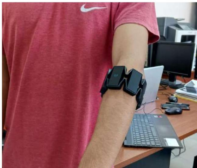
**Ilustración 3-14:** Posición Myo Armband debajo del codo
