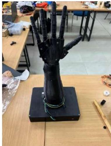
**Ilustración 2-9:** Prótesis mioeléctrica
