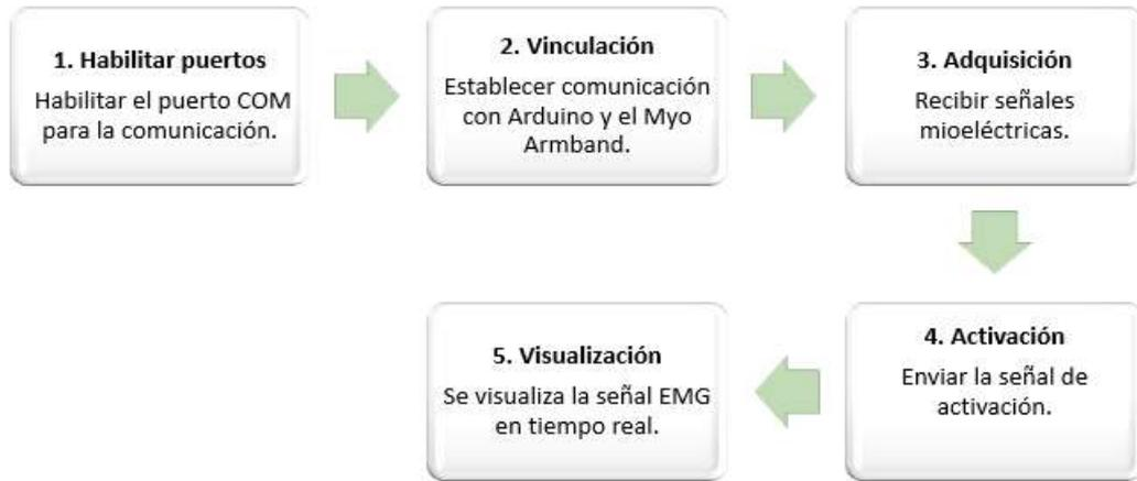
**Ilustración 3-24:** Secuencia de funcionamiento de la GUI
