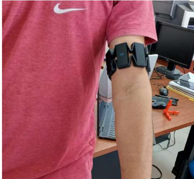
**Ilustración 3-13:** Posición Myo Armband arriba del codo
