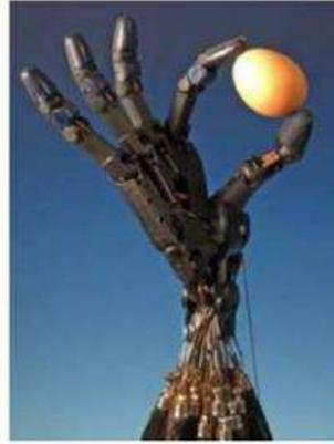
**Ilustración 2-8:** Prótesis neumática
