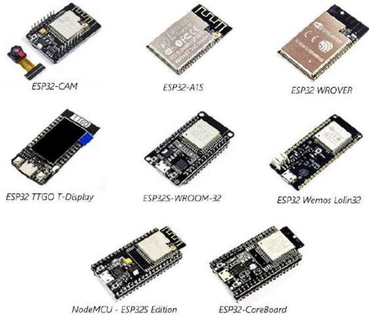
**Ilustración 2-22:** Tipos de ESP32
