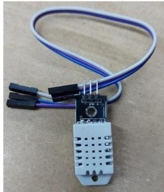
**Ilustración 3-5:** Sensor DHT22
