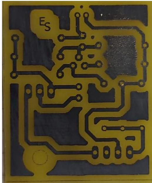
**Ilustración 3-22:** Diseño PCB del sensor de sonido en fibra de vidrio
