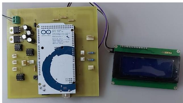
**Ilustración 3-21:** Soldadura de elementos en la placa del módulo sensores
