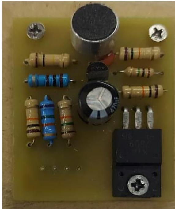
**Ilustración 3-24:** Soldadura de elementos del sensor de sonido
