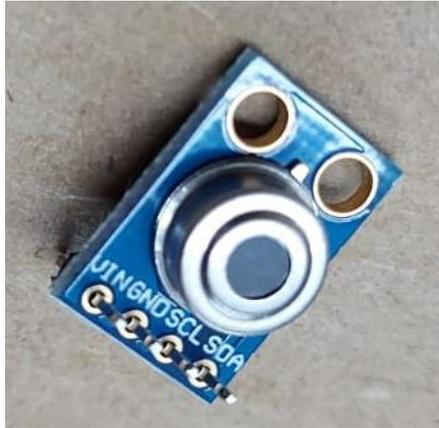
**Ilustración 3-3:** Sensor de temperatura MLX90614
