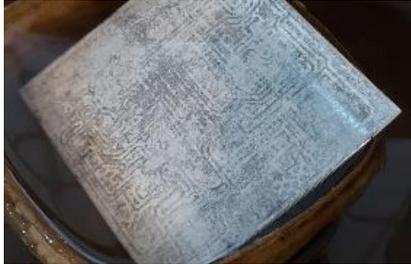
**Ilustración 3-18:** Remojo del diseño PCB
