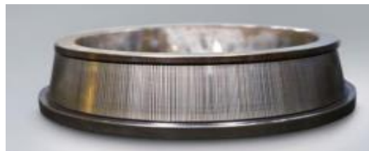
Ilustración 2-14: Corrosión en el anillo interior Fuente: Laura Telenchana y Vergara Guananga, 2022.
