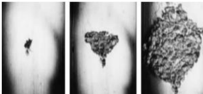
Ilustración 2-8: Falla por fatiga por contacto con impurezas Fuente: Laura Telenchana y Vergara Guananga, 2022.
