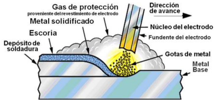
Ilustración 2-21: Proceso de soldadura Fuente:Flores, 2020.
