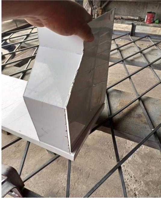
**Ilustración 3-4:** Estructura sólida de acero inoxidable para el equipo de prueba de jarras.
