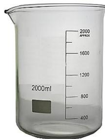
**Ilustración 2-4:** Vaso precipitado de 2000ml
