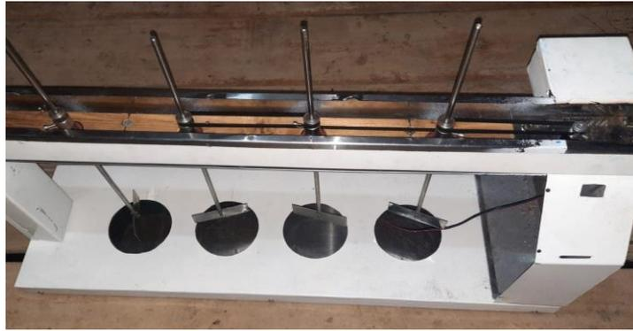
**Ilustración 3-5:** Sistema mecánico del equipo de prueba de jarras.
