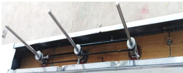
**Ilustración 4-4.** Diseño del sistema de agitación de paleta plana
