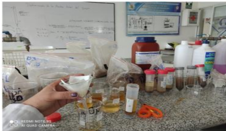
Ilustración 3-7: Submuestra extraída en laboratorio de las muestras de suelo
