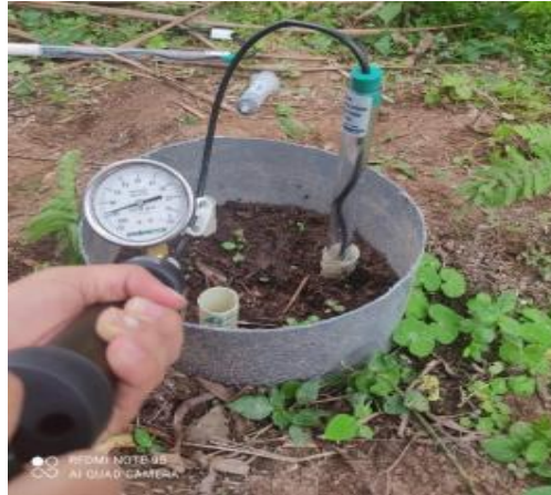
Ilustración 3-15: Extracción de lixiviados utilizando un lisímetro de succión.
