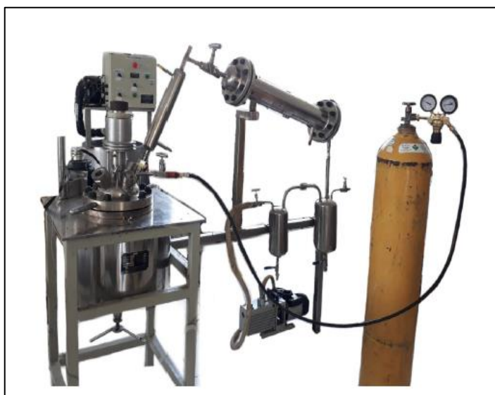
Ilustración 6-2: Equipo de pirólisis discontinua (ESPOCH)
