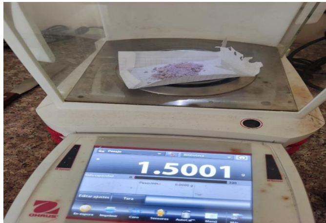
Pesaje de reactivos para la preparación de soluciones captadoras
