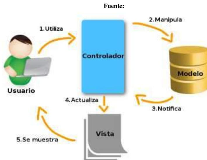
**Ilustración 3-6:** Patrón de diseño modelo-vista-controlador
