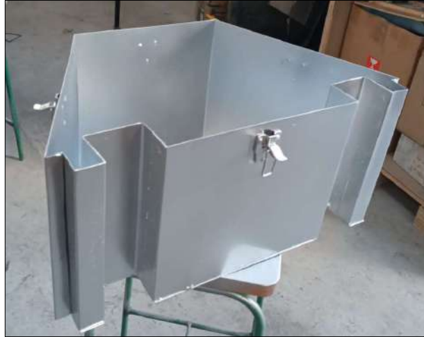
Ilustración 3-24: Contenedor de baterías
