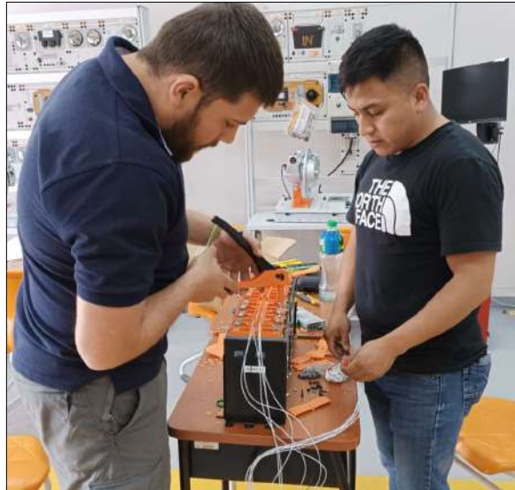
Ilustración 3-25: Proceso de conexión en serie de módulos
