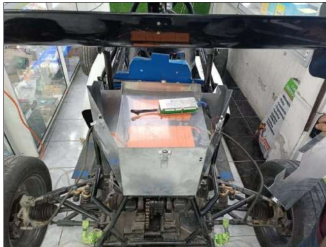
Ilustración 3-29: Sistema de contenedor y baterías montado en el vehículo
