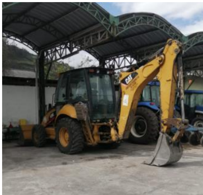
Ilustración 4-19: Retroexcavadora CAT 420-E
