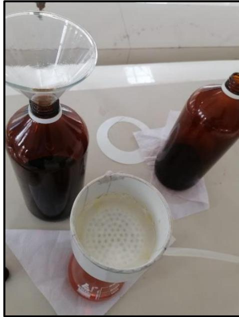
**Ilustración 3-13:** Filtración de biodiesel
