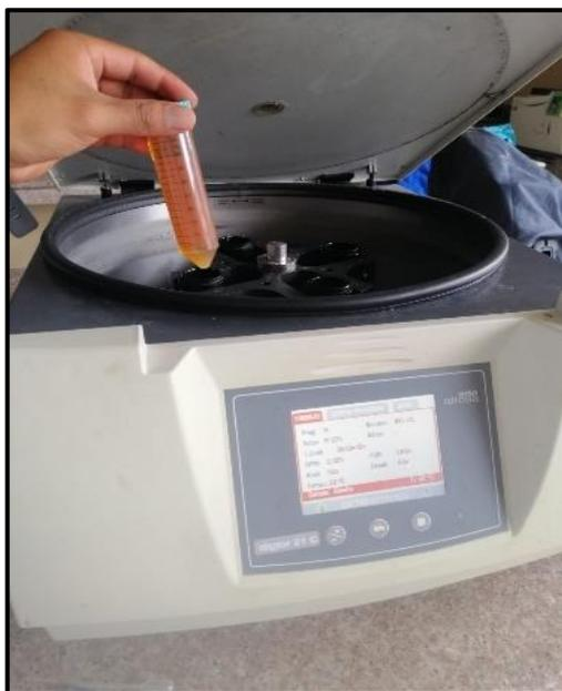
**Ilustración 3-6:** Centrifugado de biodiesel
