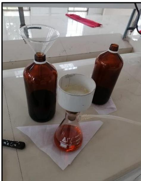
**Ilustración 3-7:** Filtración de biodiesel
