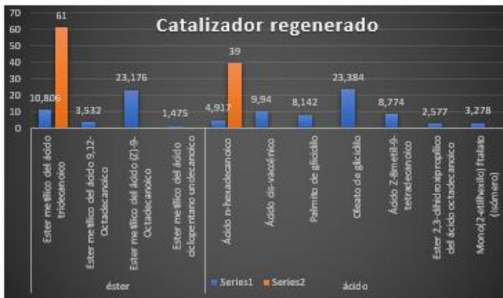
**Ilustración 4-6:** Composición de biodiesel con catalizador regenerado
