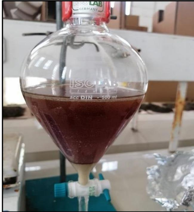
**Ilustración 3-12:** Separación de biodiesel y catalizador
