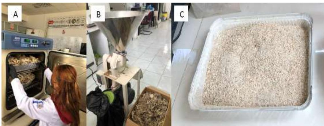
**Ilustración 3-3:** Pretratamiento de muestras; A) Secado, B) Triturado y C) Tamizado
