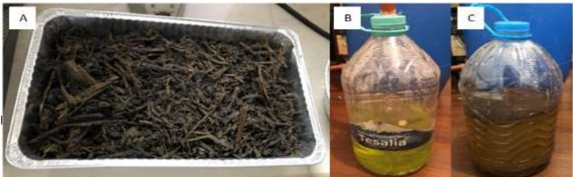
**Ilustración 4-3:** Productos de la digestión anaerobia; A) Biosol, B) Biogás en una trampa de gas y C) Biol
