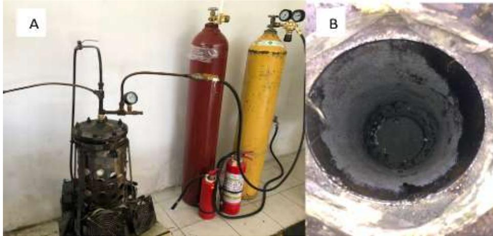
**Ilustración 3-4:** Equipo de pirólisis; A) Equipo y B) Interior del reactor
