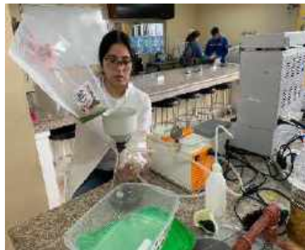
Fotografía 6. Filtración al vacío para posterior análisis.
