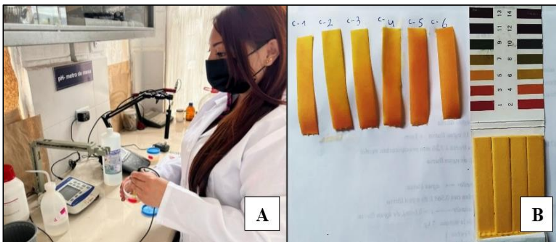
Ilustración 8-3: Medición de pH. A: Medición de pH con pH metro de mesa. B: Medición de pH con papel tornasol
