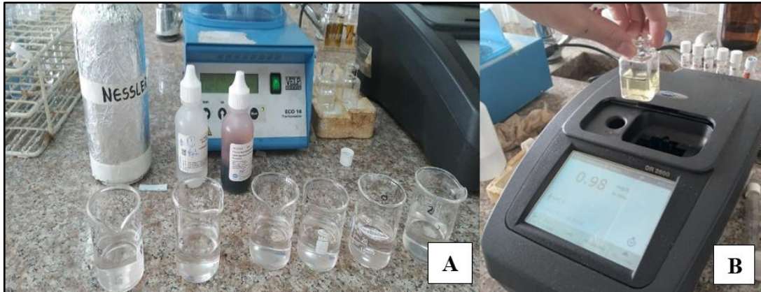
Ilustración 9-3: Determinación de la DQO. A: Muestras y reactivos para análisis. B: espectrofotómetro
