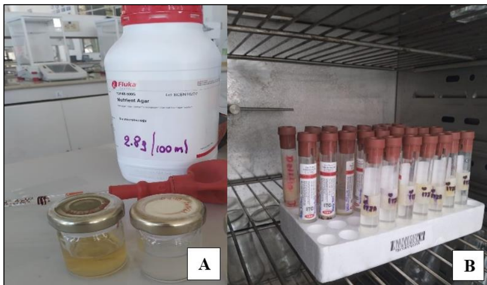
Ilustración 1-4: Siembra de bacterias electrogénicas A: Agar nutritivo y bacterias. B: incubadora.
