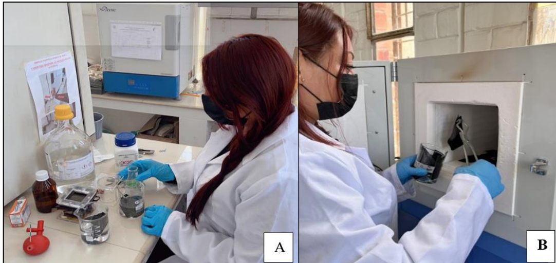
Ilustración 3-3: Tratamiento de membranas anódicas: A: Ánodos sumergidos en acetona. B: calentamiento de ánodos en mufla
