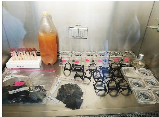
Ilustración 5-3: Esterilización de compartimientos en UV
