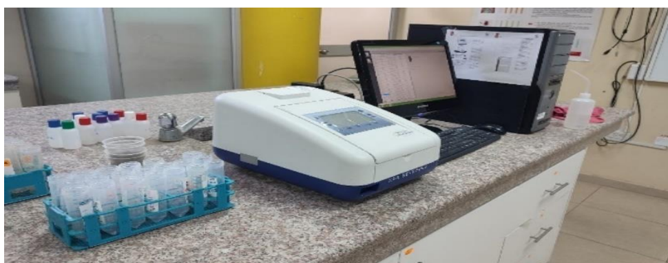
Ilustración 3-12: Determinación de fósforo usando un espectrofotómetro UV-Visible
