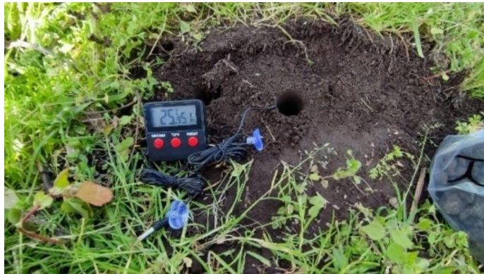
Ilustración 3-4: Medición in situ de la temperatura y humedad del suelo
