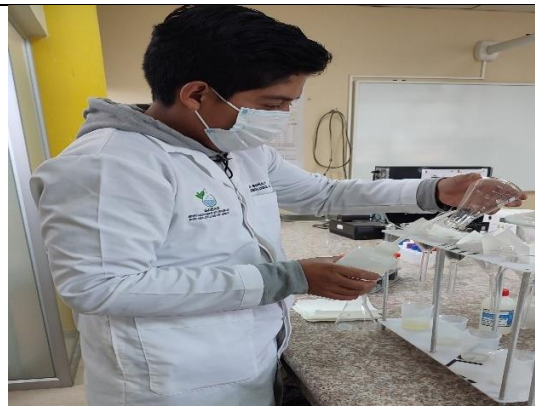
Muestras digeridas filtradas para obtener el extracto requerido para los diferentes análisis.
