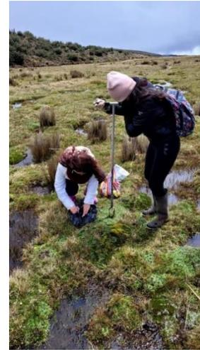
Homogenización de muestras para determinación de materia orgánica a profundidad de 0-30 y 30-60 cm,
