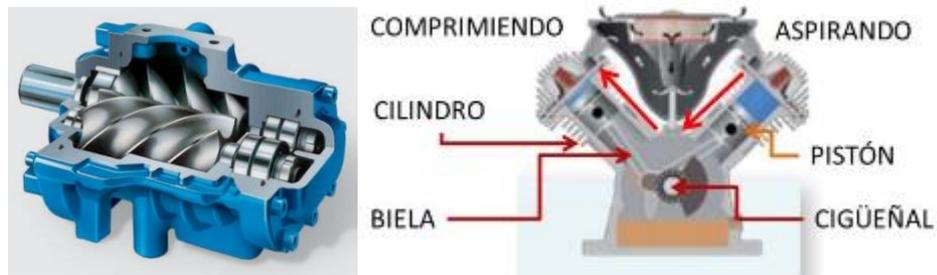
**Ilustración 1-3.** Tipos de compresores para aire comprimido
