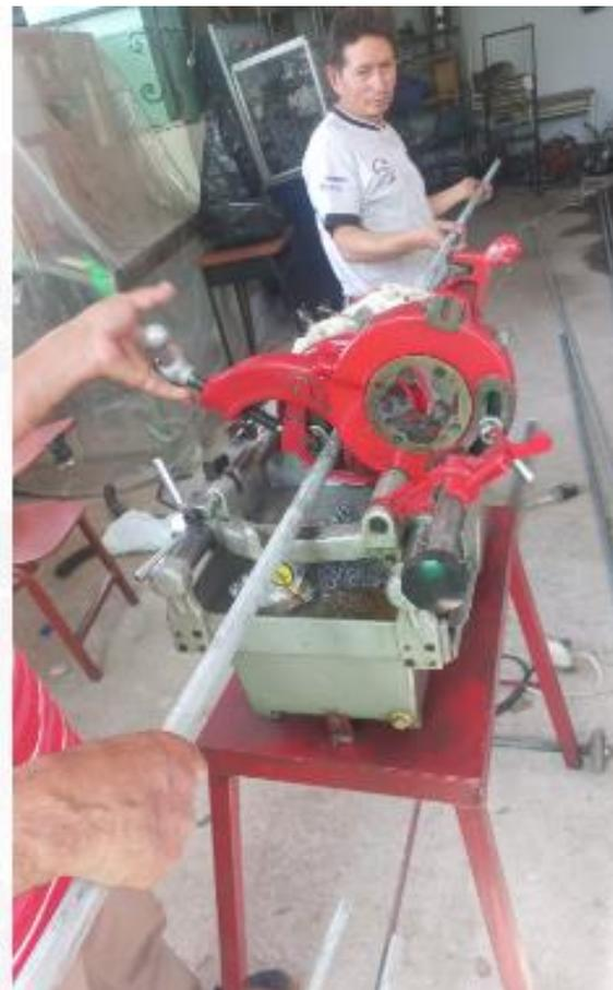
**Ilustración B-7.** Equipo de roscado de tubería
