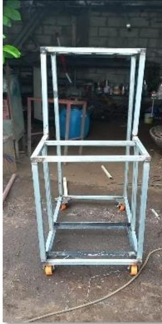
**Ilustración 4-3:** Soporte del Biofiltro
