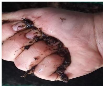
**Ilustración 15-3:** Medición de la humedad
