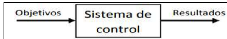
Ilustración 2-36: Componentes básicos de un sistema de control
