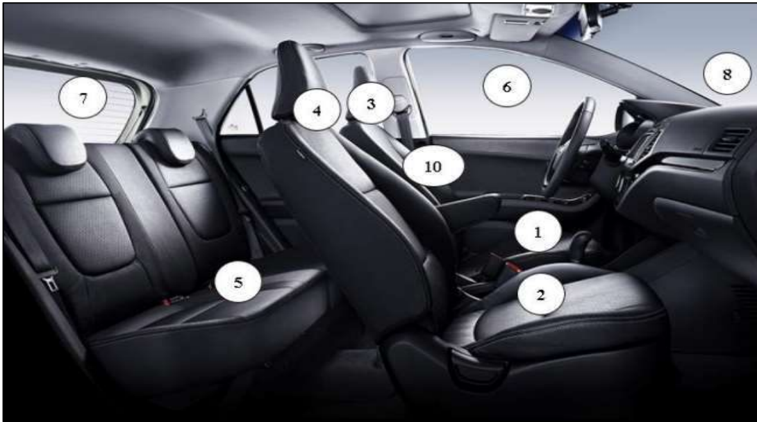
Ilustración 2-2: Ubicación de sensores de temperatura y humedad en el exterior e interior del vehículo
