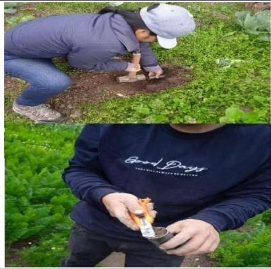
Toma de muestras de suelo por el método del cilindro.
