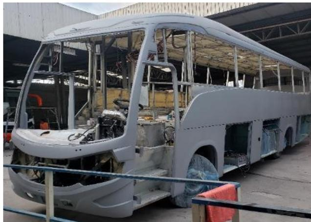
**Ilustración 2-4:** Carrocería de bus sobre chasis independiente
