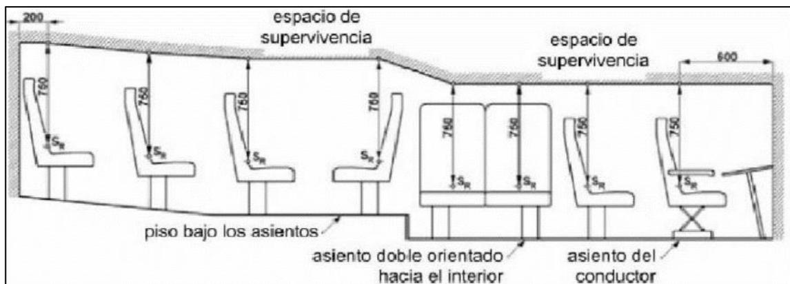
**Ilustración 2-8:** Especificación del espacio de supervivencia disposición longitudinal
