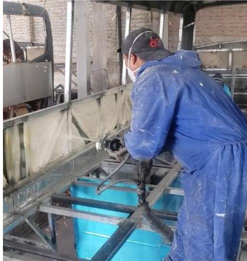
**Ilustración 2-14:** Aplicación de la espuma de poliuretano en superficie vertical
