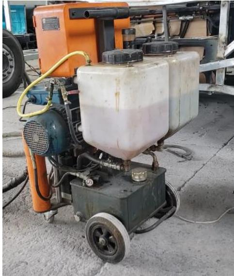
**Ilustración 2-13:** Equipo de proyección de alta presión
