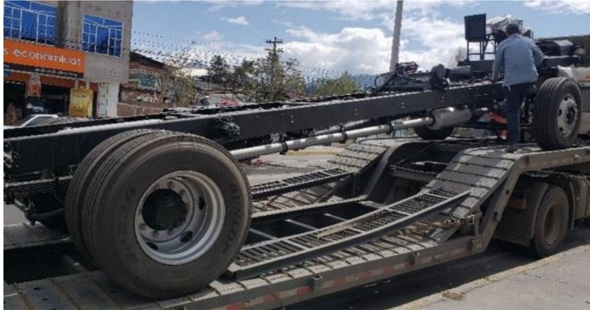
**Ilustración 2-3:** Chasis independiente de dos ejes con tracción posterior
