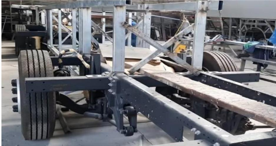
**Ilustración 2-5:** Construcción de carrocería autoportante chasis modular Scania k360
