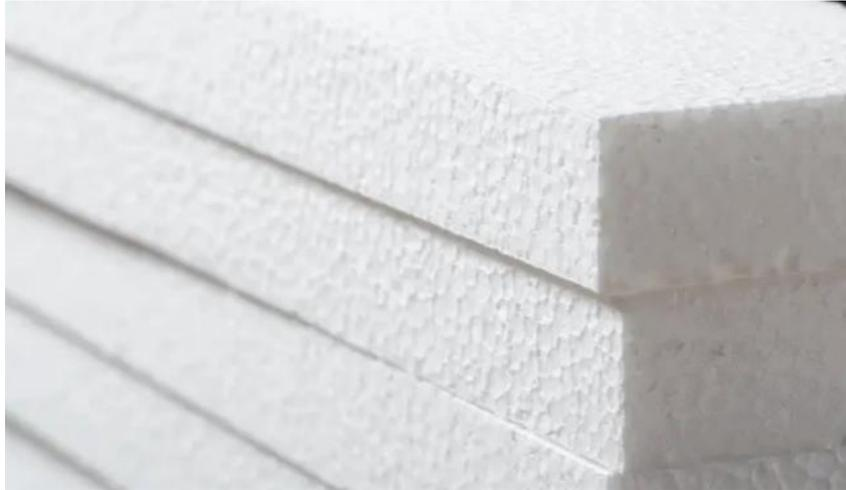
**Ilustración 2-15:** Poliestireno Expandido (EPS)
