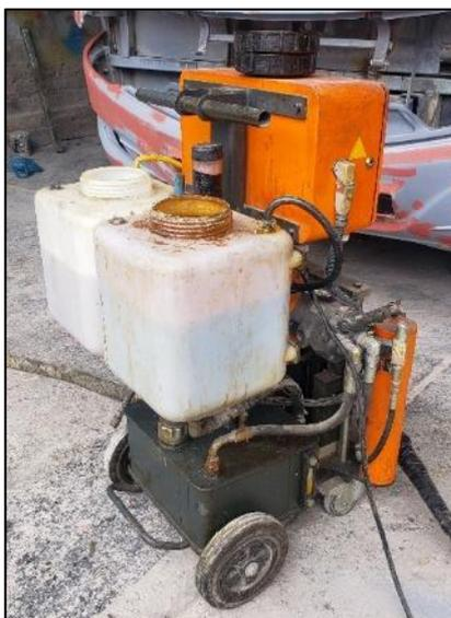
**Ilustración 3-8:** Depósitos de polioliol e isocianato con 20 kg de componentes cada uno
