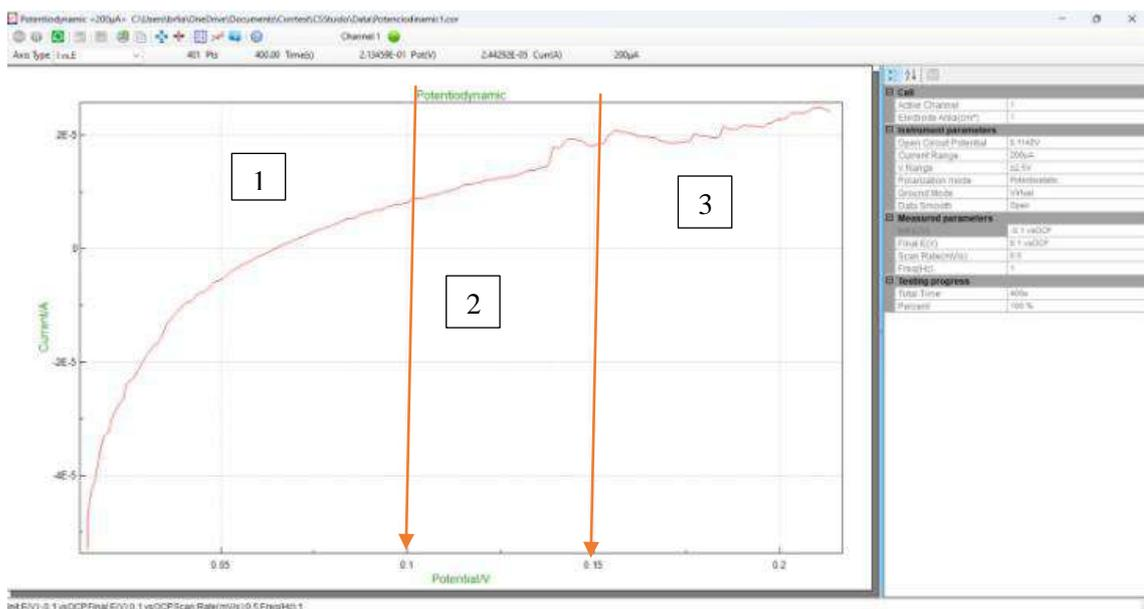
**Ilustración 4-12:** Polarización de la CCM Amarilla 3
