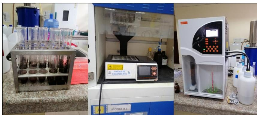
**Ilustración 3-16:** Análisis nitrógeno por el método kjeldahl
