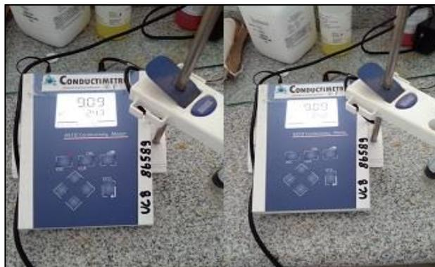
**Ilustración 3-14:** Análisis de conductividad eléctrica
