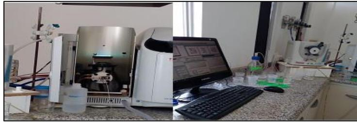
**Ilustración 3-19:** Equipo fotómetro de llama
