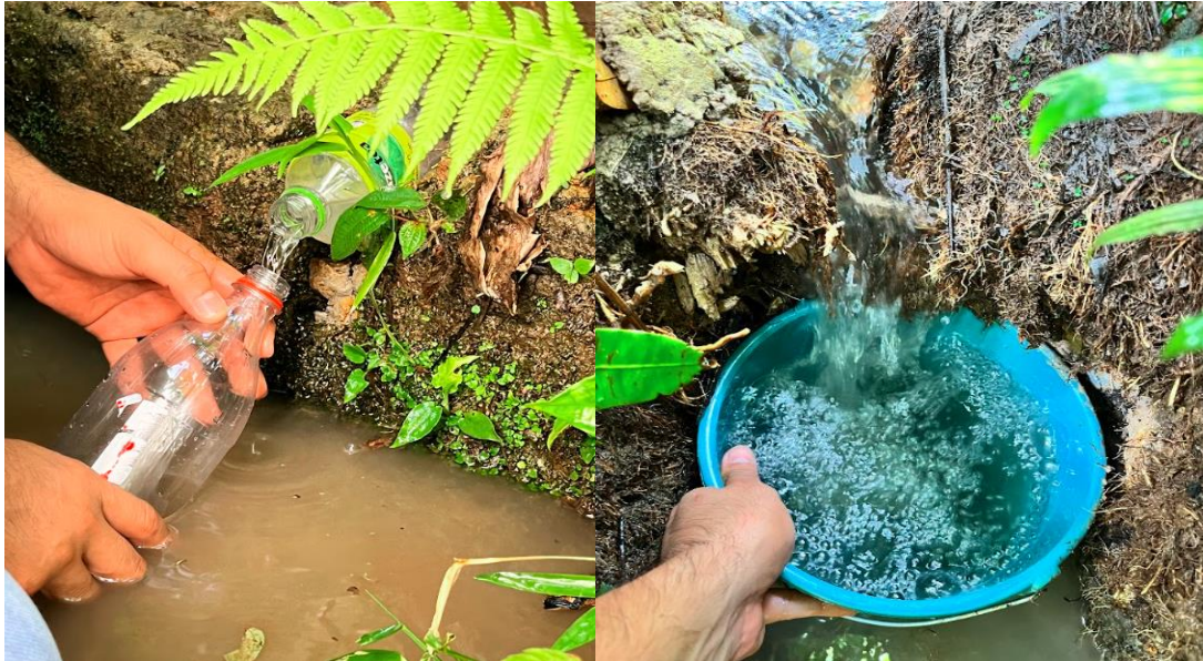
Ilustración 3-3: Medición de caudal con el método volumétrico; con recipiente de 1L (izquierda) y recipiente de 10 L (derecha)
