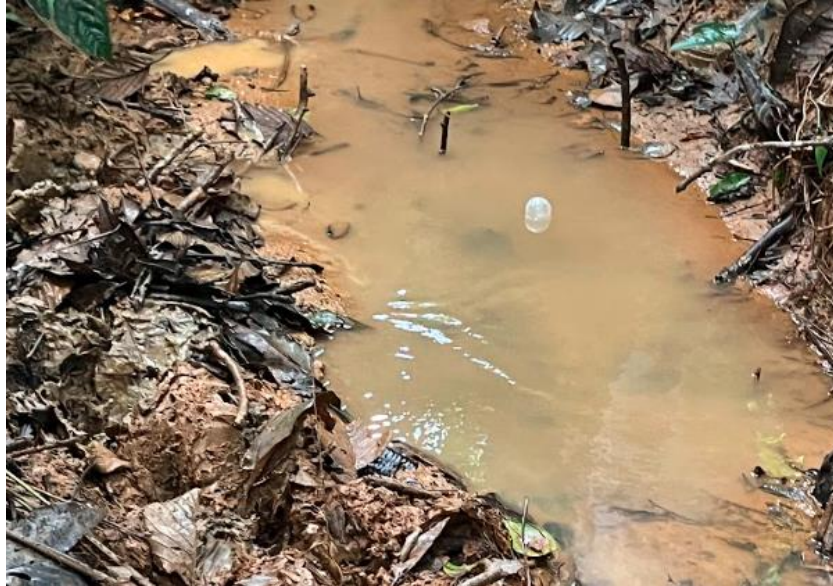
Ilustración 3-7: Lanzamiento de flotador en la sección delimitada
