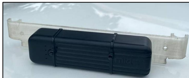
Ilustración 3-7: Soporte para la batería de la cámara MicaSense RedEdge-MX
