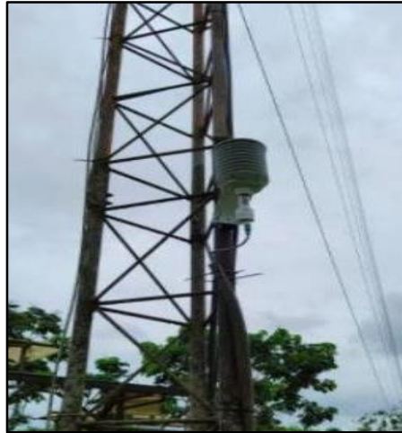
Ilustración 3-10: Sensor HMP-155 de temperatura y humedad
