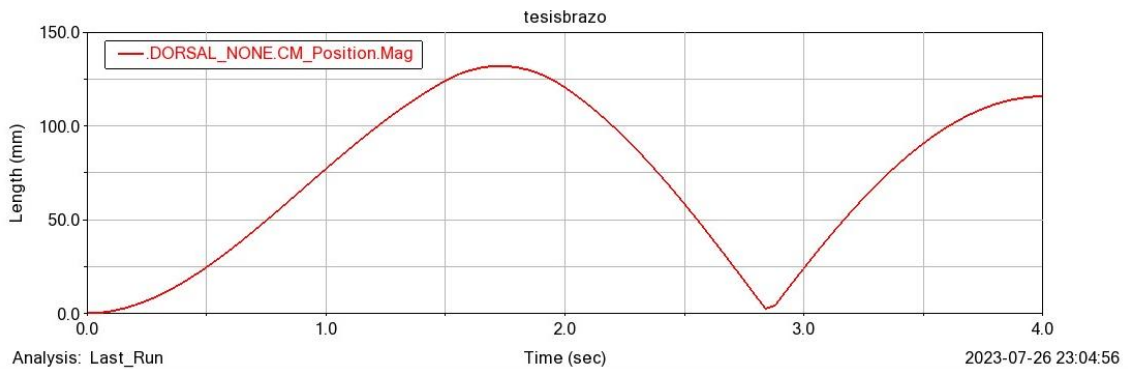
Ilustración 4- 1: Gráfica de posición vs tiempo de la muñeca de la prótesis.
