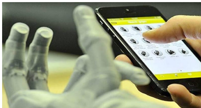
Ilustración 2-10: Prótesis activada mediante el celular
