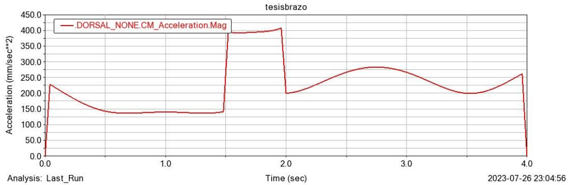
Ilustración 4- 3: Gráfica de aceleración vs tiempo de la muñeca de la prótesis.
