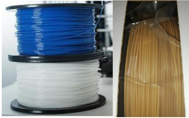
Ilustración 2-7: Material PLA para impresión 3D
