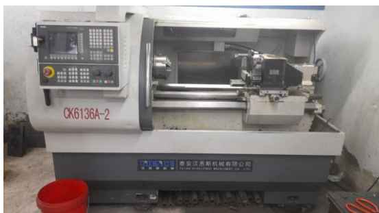
Ilustración 4-7: Torno CNC para mecanizado del husillo
