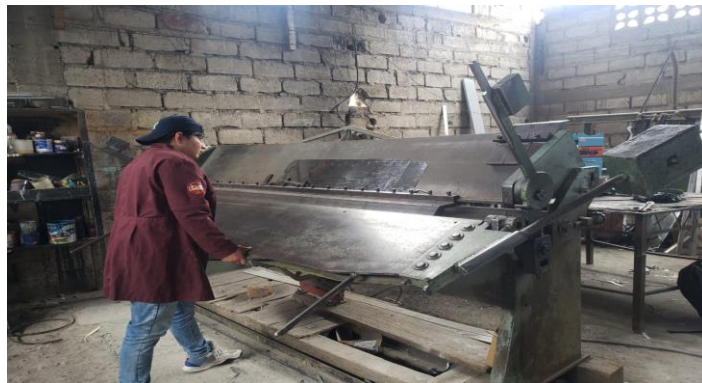
Ilustración 4-6: Proceso de doblado realizado para la carcasa del extractor
