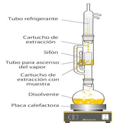
Ilustración 2-9: Extracción Soxhlet
