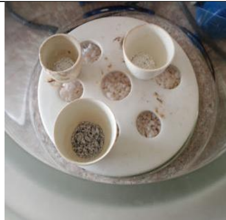
Pesado final después de la incineración
