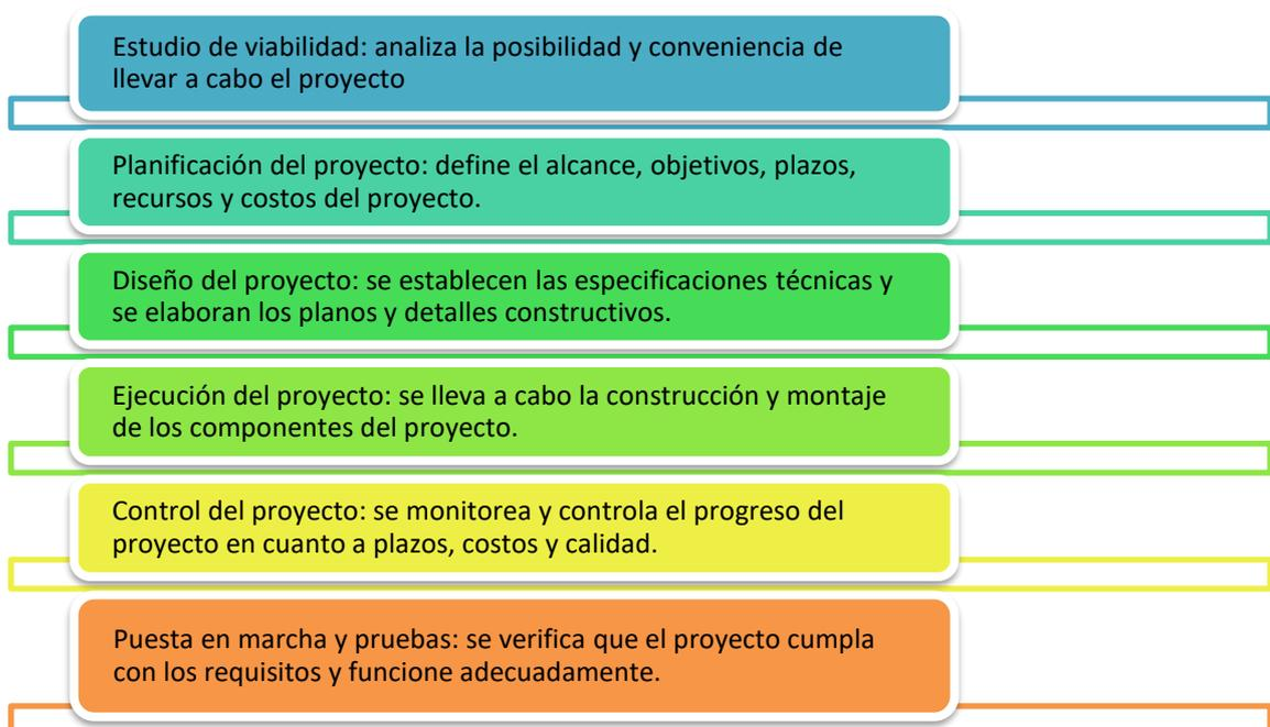
**Ilustración 2-9:** Componentes de la ingeniería del proyecto
