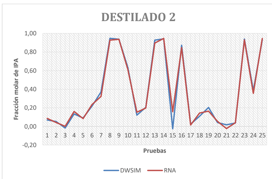
Figura 25-4: Fracción molar de isopropanol en el destilado de la segunda columna en la validación.
