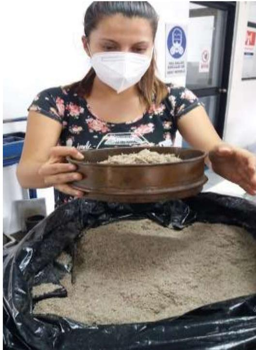
**Ilustración 4-2:** Tamizado del bagazo de caña.
