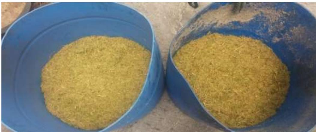
**Ilustración 4-3:** Bagazo de caña de azúcar seco. Izquierda: Tamizado. Derecha: Sin tamizar
