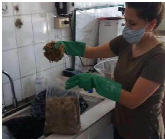
**Ilustración 4-6:** Inoculado del bagazo de caña con sustratos unicelulares
