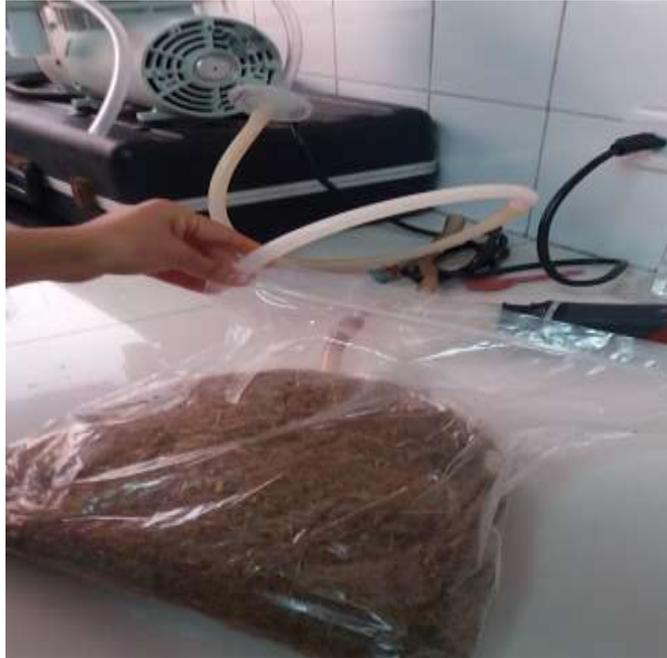
**Ilustración 4-7:** Eliminación de aire de las bolsas
