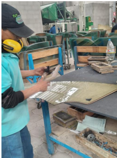
Ilustración 3-4: Proceso de sellado
