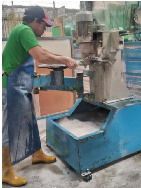
Ilustración 3-2: Proceso de pulido
