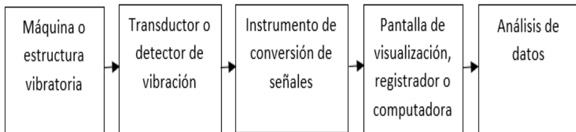
Ilustración 2-4: Esquema de medición de vibración
