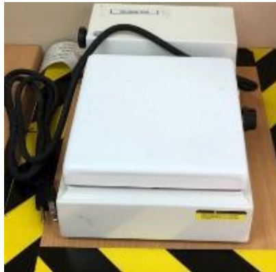
Ilustración 3-8: Placas calientes Nuova II
