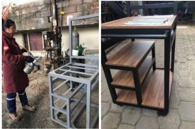
Ilustración 3-32: Pintura y ensamblaje de las maderas de la estructura metálica.
