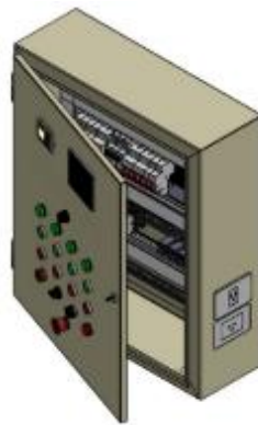
Ilustración3-16: Vista isométrica del tablero metálico
