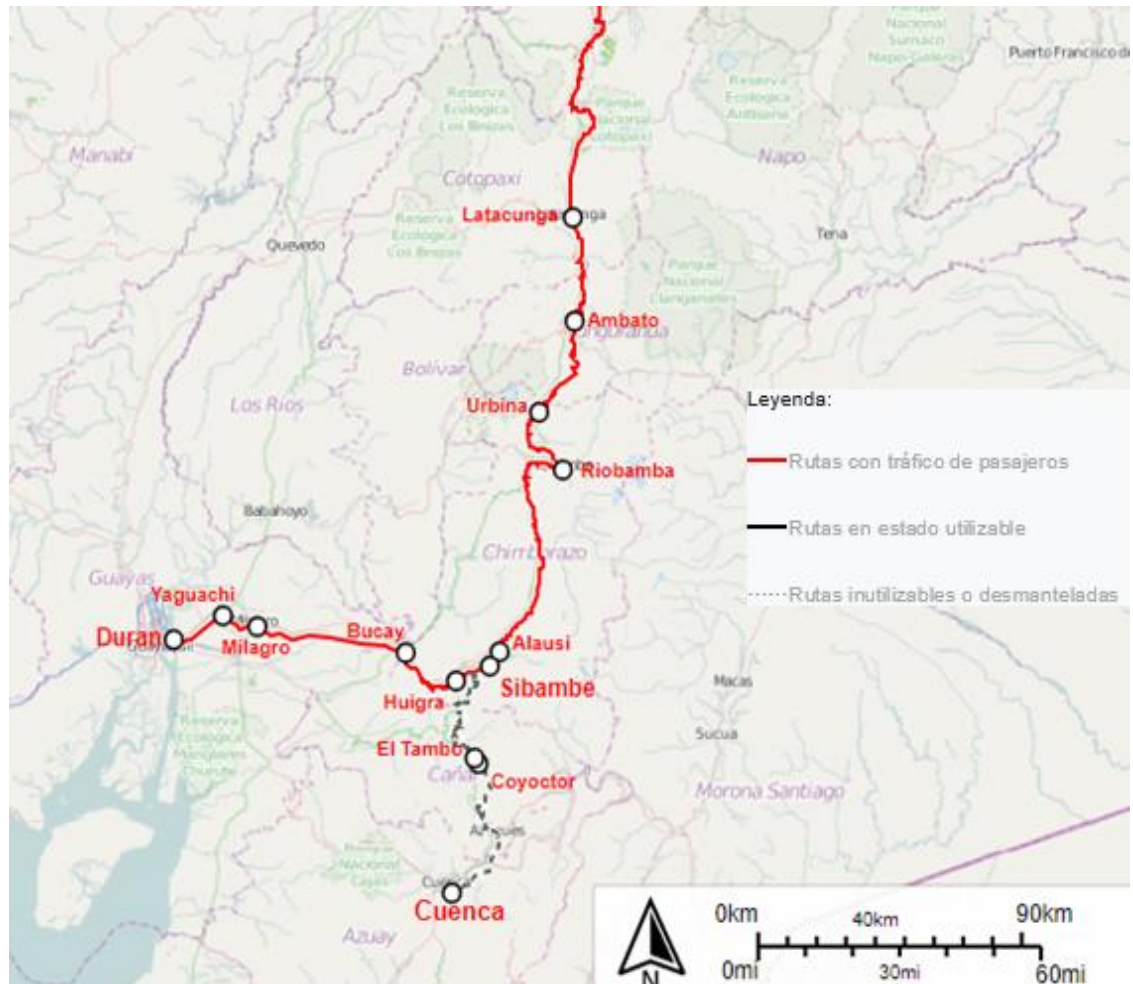
Ilustración 1-5: Tramos rehabilitados y sin rehabilitar
