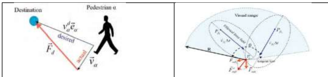
Ilustración 2-5: Descripción de la relación de la fuerza de dirección y reacción
