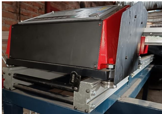
Ilustración 3-40: Montaje del cuerpo principal del robot cartesiano Realizado por: Quinllin H., 2024
