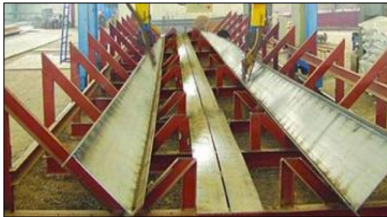
Ilustración 2-6: Ensamble de vigas IPE posición inclinada.
