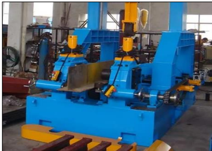
Ilustración 2-5: Ensamble de vigas IPE posición vertical.
