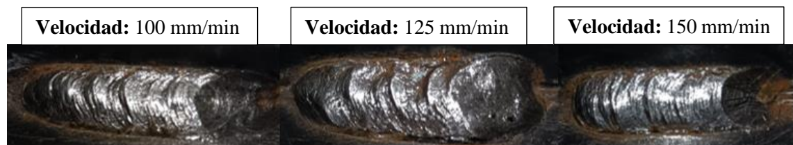
Ilustración 4-3: Tercera prueba de soldadura
