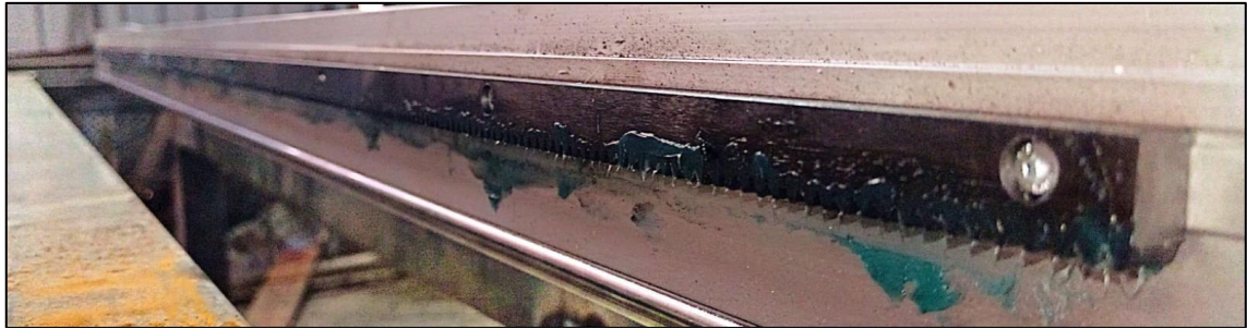
Ilustración 3-34: Cremallera del riel guía transversal
