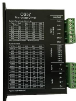
OS57 Ilustración 3-18: Driver de motores Realizado por: Quinllin H., 2024
