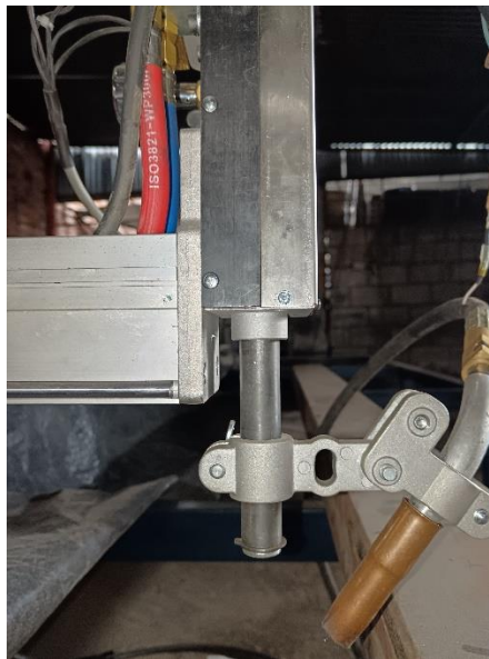
Ilustración 3-43: Montaje de la antorcha MIG Realizado por: Quinllin H., 2024
