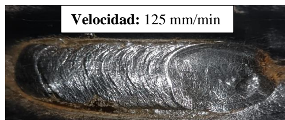
Ilustración 4-6: Segunda prueba con velocidad de avance de 125 mm/min y 21V
