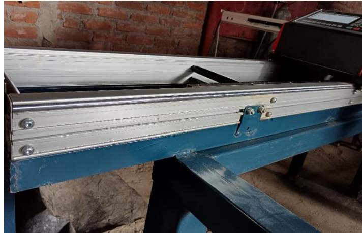
Ilustración 3-39: Montaje del riel guía longitudinal Realizado por: Quinllin H., 2024
