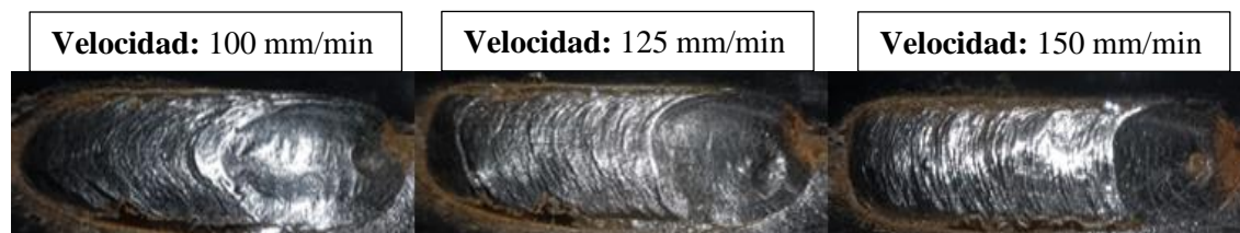
Ilustración 4-2: Segunda prueba de soldadura
