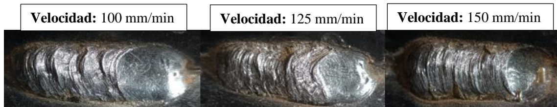
Ilustración 4-4: Cuarta prueba de soldadura
