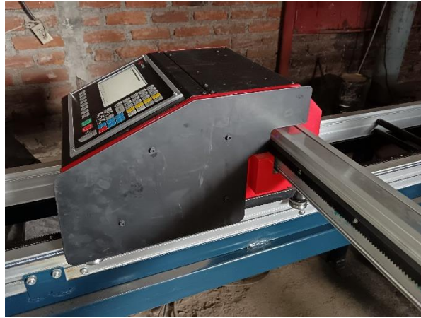
Ilustración 3-41: Montaje del riel guía transversal Realizado por: Quinllin H., 2024
