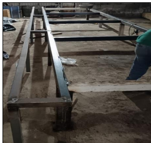
Ilustración 3-27: Ensamble de bases para la implementación Realizado por: Quinllin H., 2024
