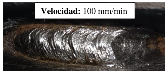
Ilustración 4-5: Tercera prueba con velocidad de avance de 100 mm/min y 22V
