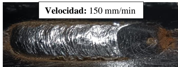
Ilustración 4-7: Segunda prueba con velocidad de avance de 150 mm/min y 21V
