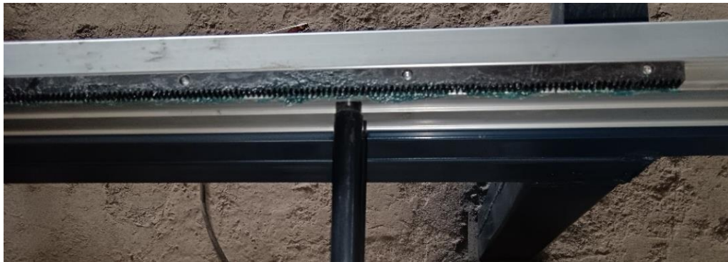
Ilustración 3-32: Cremallera del riel guía longitudinal Realizado por: Quinllin H., 2024
