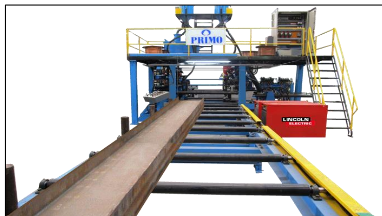
Ilustración 2-3: Ensamble de vigas IPE posición horizontal.
