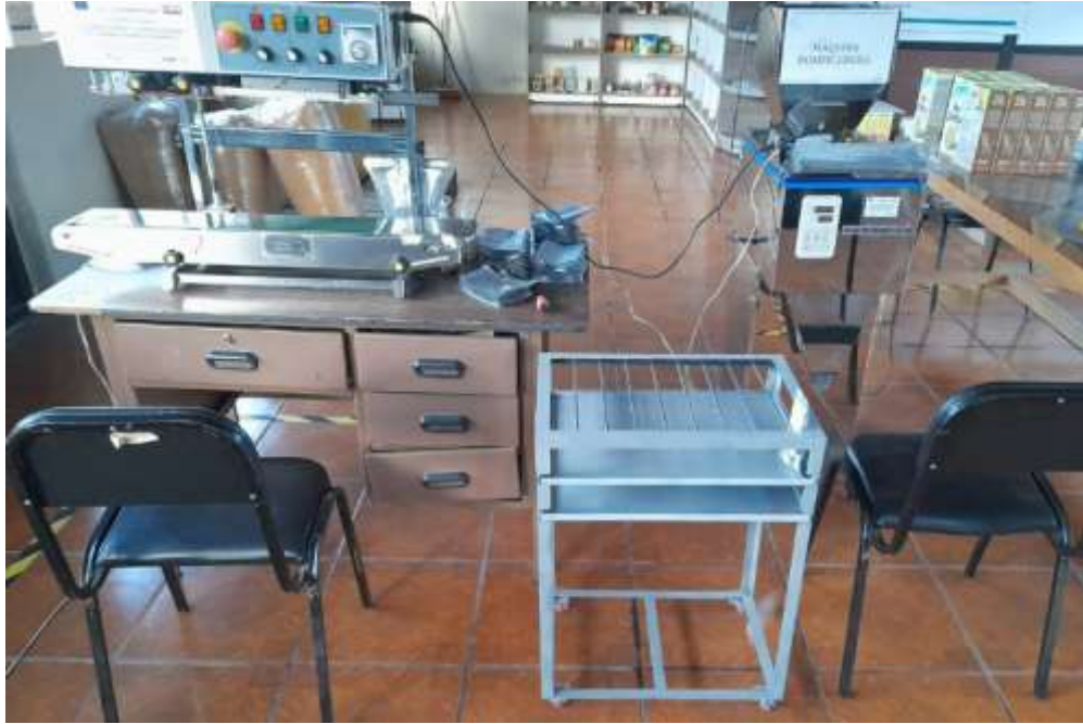
Ilustración 3-52: Mesa de transporte en área de dosificado y sellado
