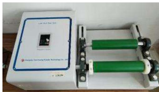
**Ilustración 4-16: Agitador de Rodillo.**
