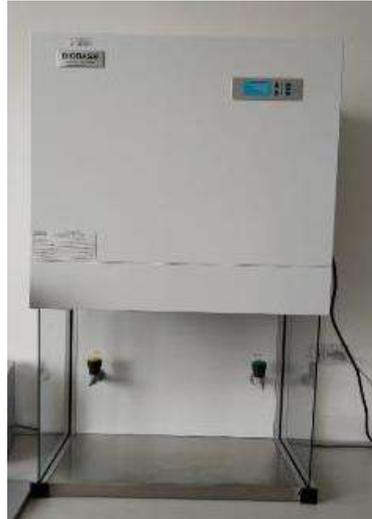
**Ilustración 4-12:** Cabina de Flujo Laminar.
