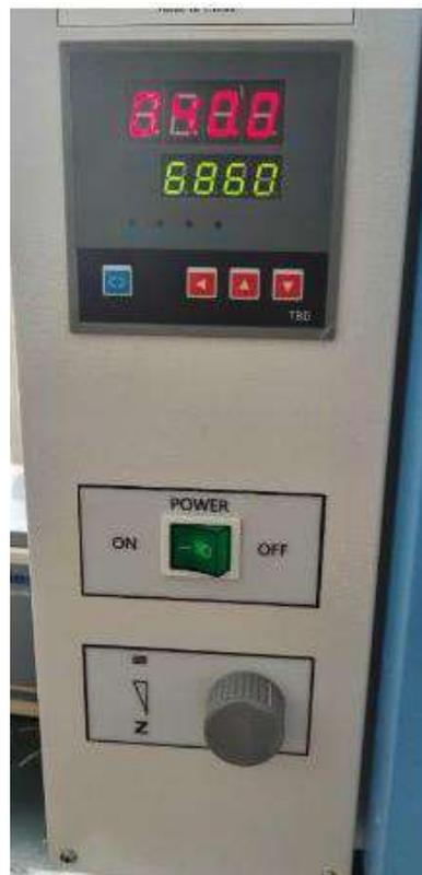
**Ilustración 4-5:** Panel de control de horno de secado.
