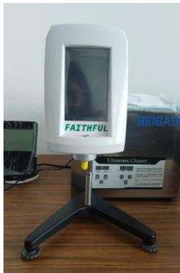
**Ilustración 4-19:** Viscosímetro.
