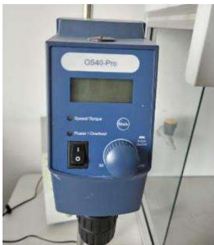
**Ilustración 4-3:** Panel de control de agitador de hélice.
