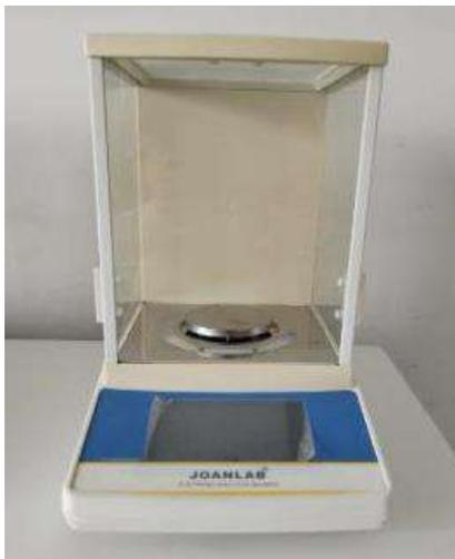
**Ilustración 4-11:** Balanza Analítica.
