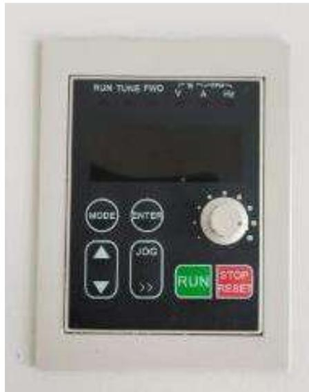
**Ilustración 4-6:** Panel de control agitador de rodillo
