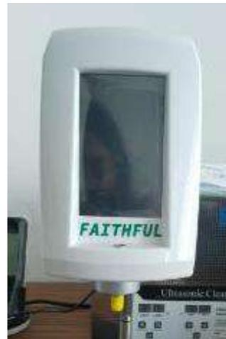
**Ilustración 4-9:** Panel de control de viscosímetro.
