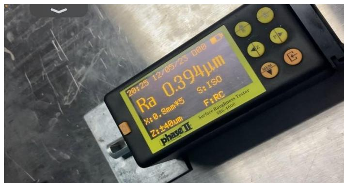
**Ilustración 3-35:** Medición de la rugosidad en probetas de la cámara de corrosión
