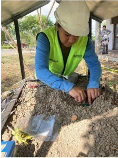
**Ilustración 3-22:** Extracción de las probetas de ADELCA
