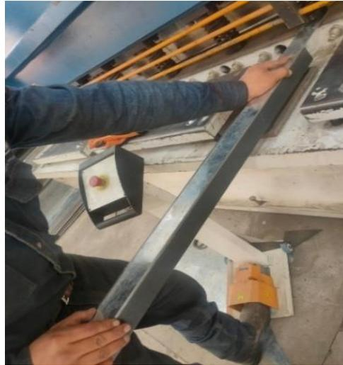
**Ilustración 3-4:** Corte del acero ASTM A36
