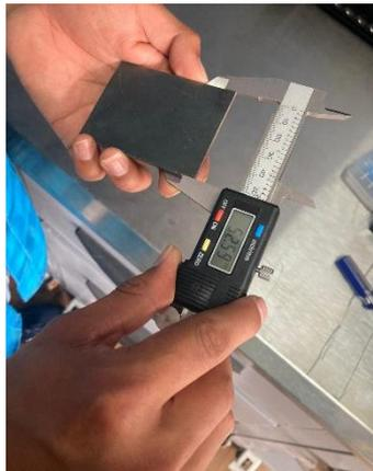
**Ilustración 3-6:** Medición con el calibrador
