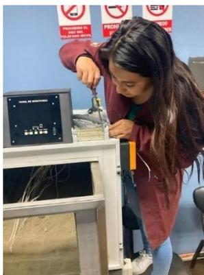
**Ilustración 3-18:** Conexión a la fuente de voltaje
