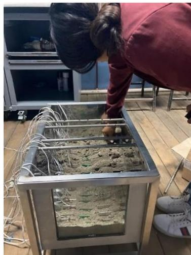
**Ilustración 3-16:** Colocación de las probetas
