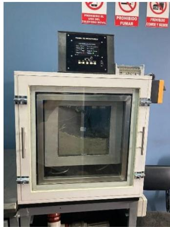
**Ilustración 3-20:** Cámara de corrosión encendida
