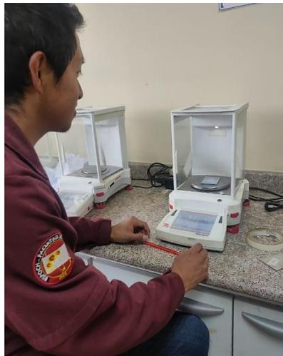
**Ilustración 3-9:** Pesaje de probetas
