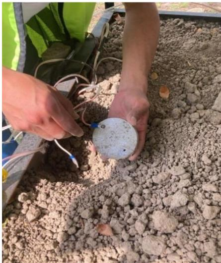
**Ilustración 3-23:** Extracción del ánodo de sacrificio de ADELCA
