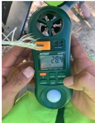
**Ilustración 3-21:** Medición de la temperatura y humedad
