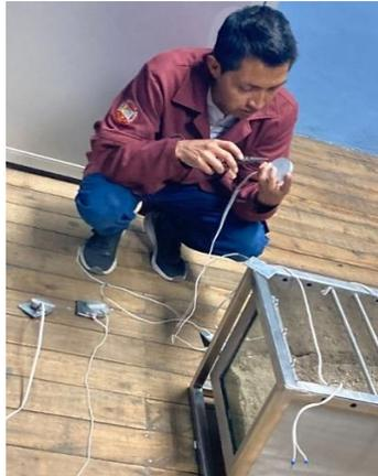
**Ilustración 3-15:** Conexión de los ánodos de sacrificio
