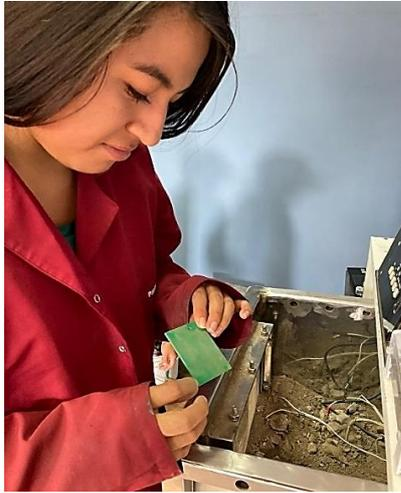
**Ilustración 3-32:** Extracción de probetas de la cámara de corrosión
