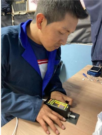
**Ilustración 3-11:** Medición de la rugosidad
