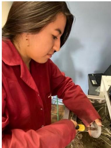
**Ilustración 3-31:** Extracción del ánodo de sacrificio del laboratorio ESPOCH
