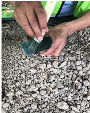
**Ilustración 3-25:** Limpieza de probetas de la estación de Milagro
