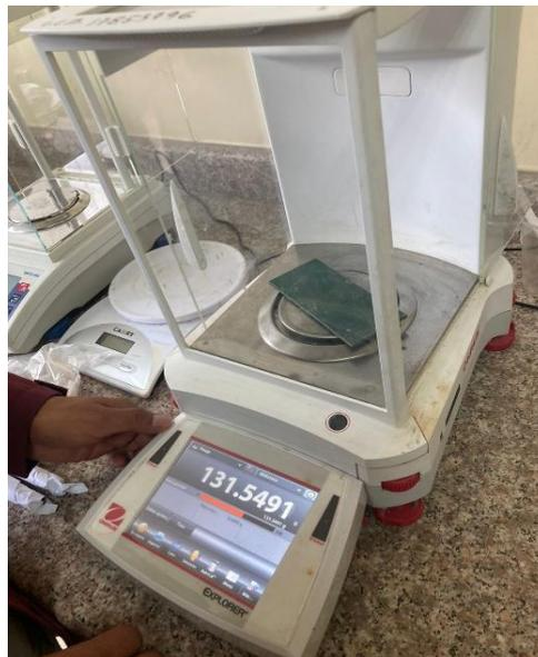
**Ilustración 3-27:** Pesado final de probetas de la estación de Milagro
