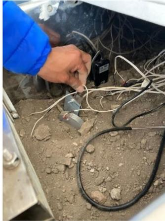
**Ilustración 3-30:** Extracción de la probeta con protección catódica
