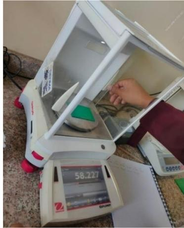
**Ilustración 3-34:** Pesaje final de las probetas de la cámara de corrosión
