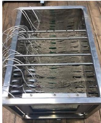
**Ilustración 3-17:** Probetas colocadas en la cámara de corrosión
