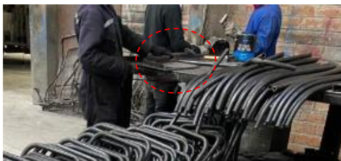
Ilustración 3-6: Medición y rayado de tubo
