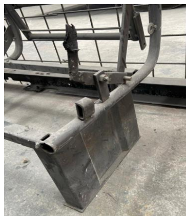
Ilustración 3-14: Colocación de soportes
