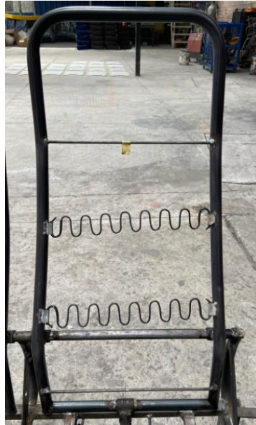
Ilustración 3-11: Suelda de espaldares
