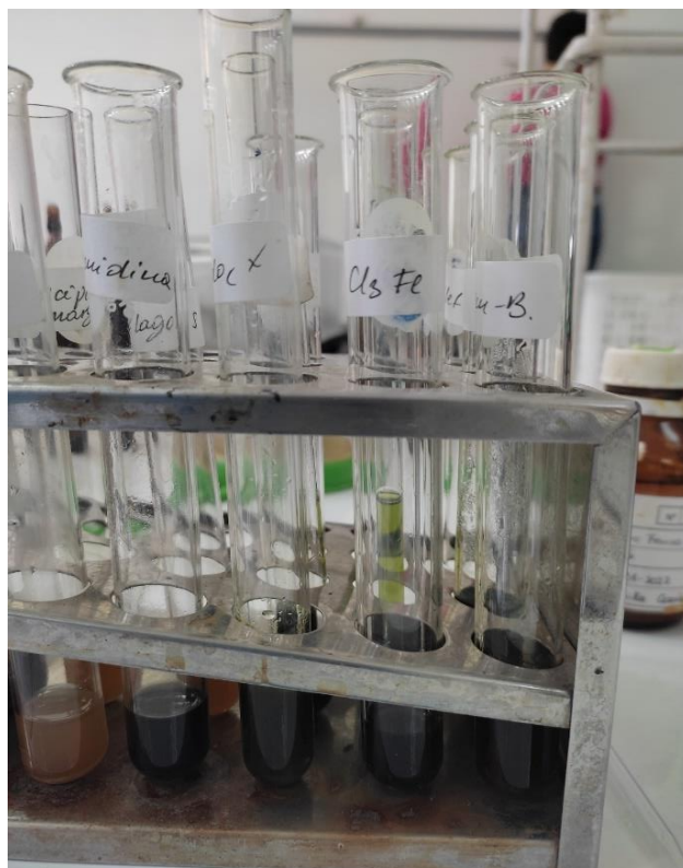
Coloración verde intensa en el tubo con \text{Cl}_3\text{Fe}
