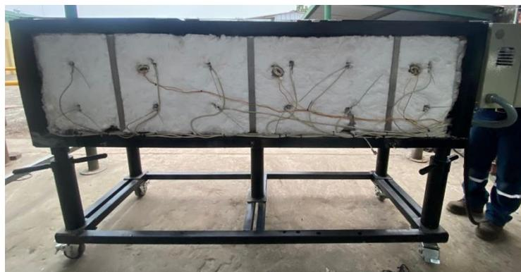
**Ilustración 3-54:** Conexiones de las resistencias eléctricas
