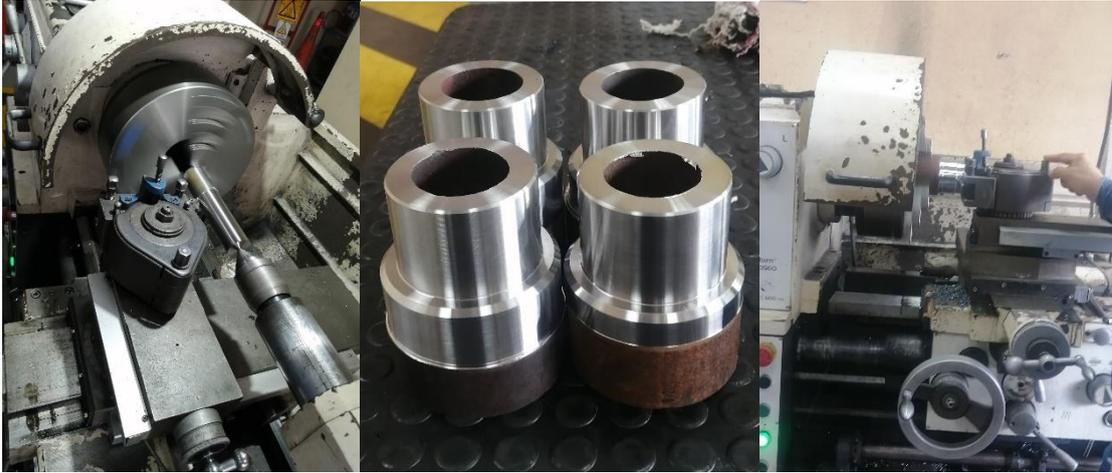
**Ilustración 3-30:** Proceso de torneado de las piezas para los parantes y bisagras
