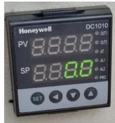
**Ilustración 3-8:** Controlador Honeywell DC1010
