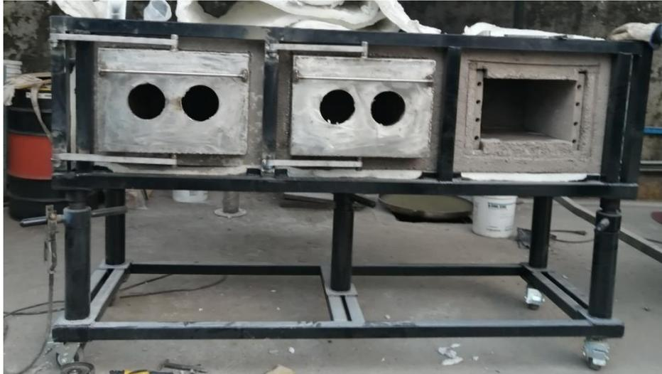
**Ilustración 3-49:** Montaje de las puertas de la cámara de calor en la estructura
