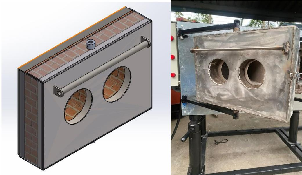
**Ilustración 4-4:** Puertas de la cámara de calor, diseño vs real
