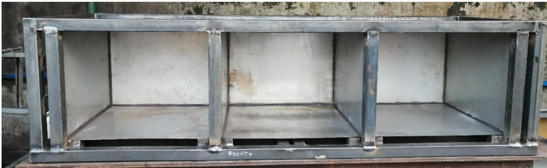
**Ilustración 3-28:** Perspectiva del montaje de las cámaras en la estructura
