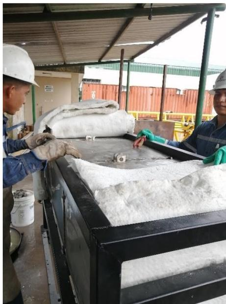
**Ilustración 3-50:** Colocación del aislante de fibra cerámica
