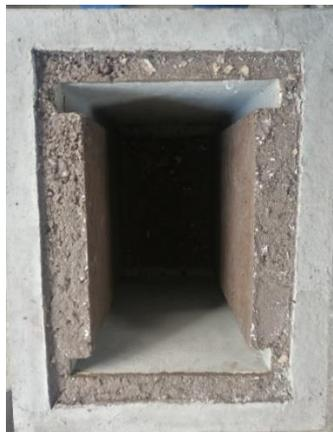
**Ilustración 3-41:** Cámara de calor sin las placas porta resistencias.
