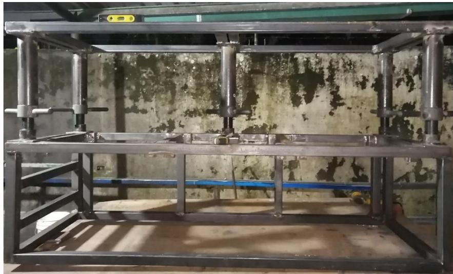
**Ilustración 3-33:** Ensamble de la estructura del horno
