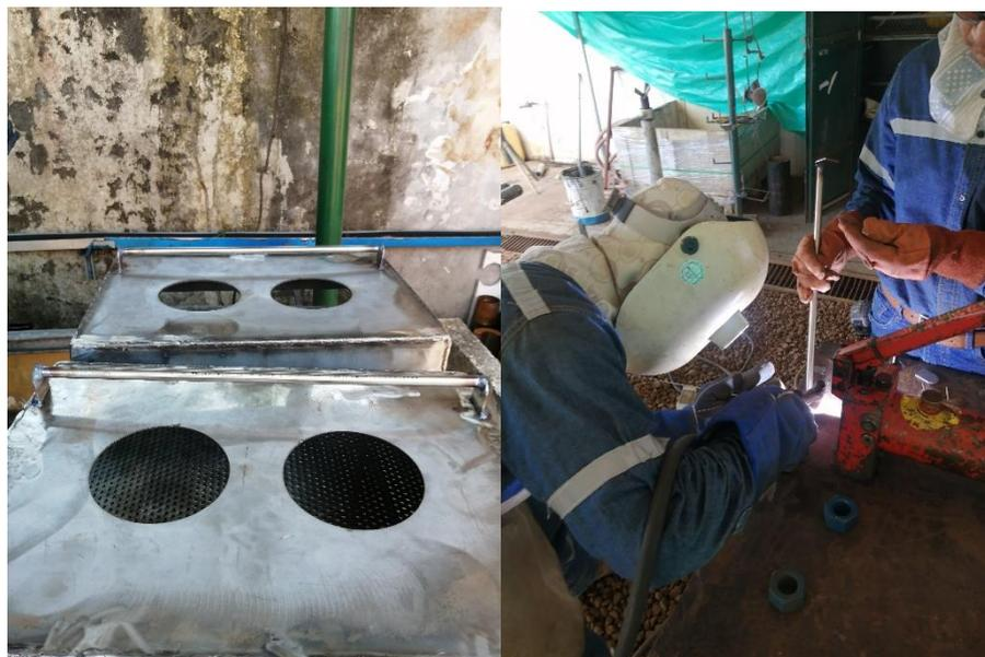
**Ilustración 3-29:** Construcción de las tapas para el horno.
