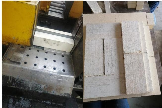
**Ilustración 3-38:** Señalado y corte de los ladrillos refractarios
