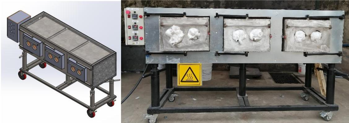
**Ilustración 4-6:** Horno para tratamiento térmico de alivio de tensión, diseño vs real
