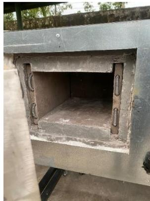
**Ilustración 3-58:** Disposición de las resistencias en la cámara de calor
