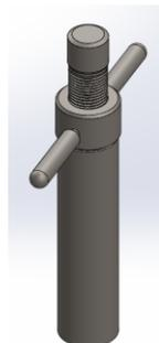
**Ilustración 3-13:** Parante con regulación manual (Tuerca, Tubo guía base)
