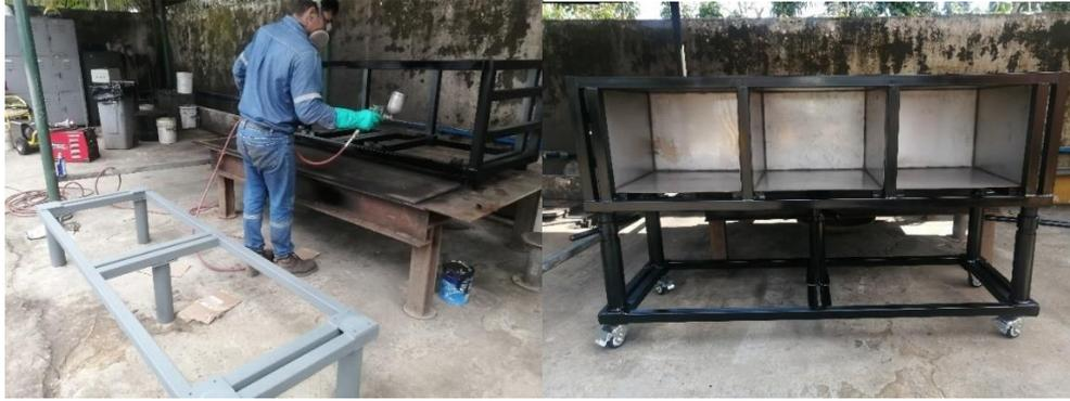
**Ilustración 3-36:** Aplicación de la pintura final a la estructura
