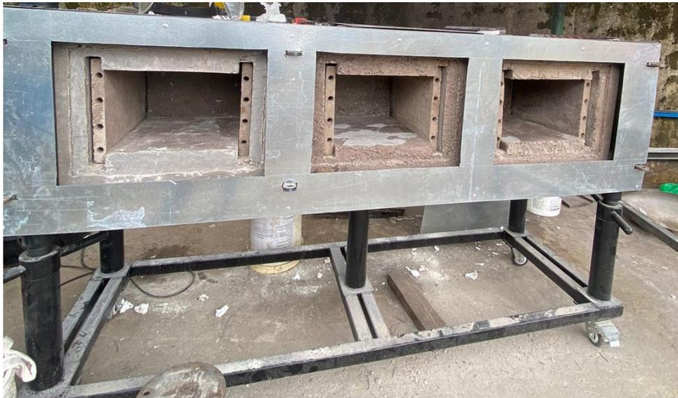
**Ilustración 4-3:** Cámaras de calor montadas en la estructura con las placas porta resistencias
