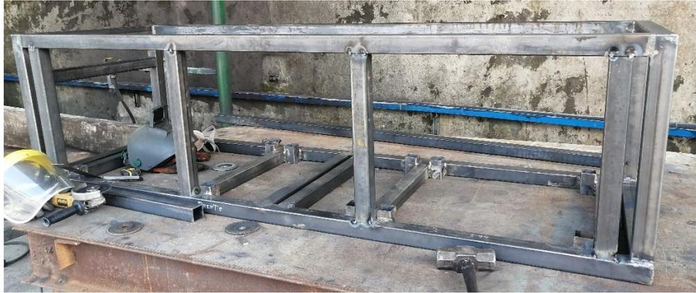
**Ilustración 3-23:** Estructura de las cámaras antes del proceso de pintura
