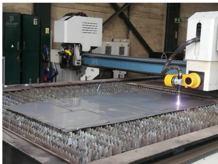
**Ilustración 3-26:** Realización de cortes de las placas
