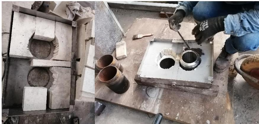
**Ilustración 3-42:** Corte y armado de las puertas de las cámaras de calor
