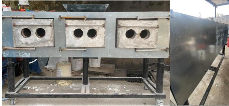
**Ilustración 3-51:** Colocación de las planchas de acero galvanizado y puertas traseras
