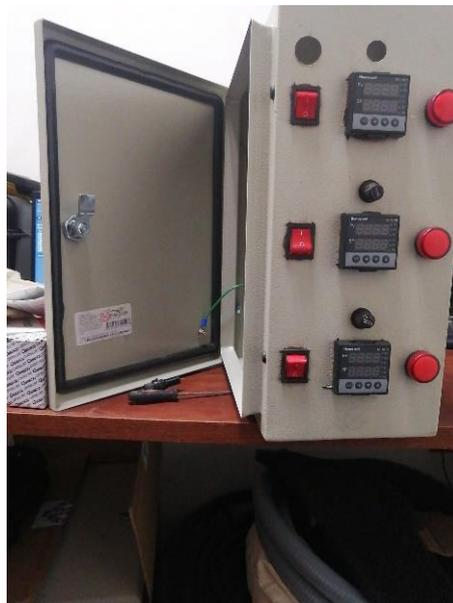
**Ilustración 3-46:** Montaje de los elementos y el cableado en el tablero de control
