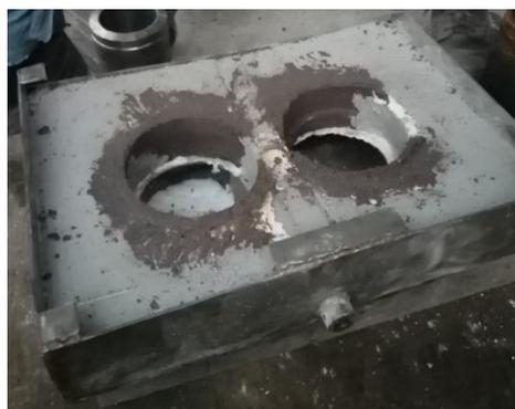
**Ilustración 3-43:** Puerta de la cámara de calor sin la placa de concreto
