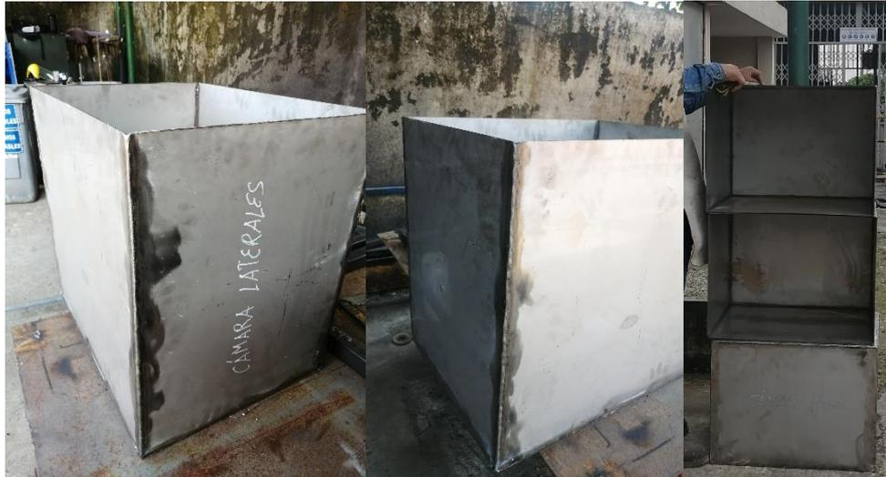
**Ilustración 3-27:** Construcción de las cajas de las cámaras de calor
