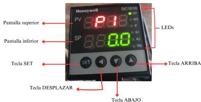
**Ilustración 3-59:** Interfaz del operador del controlador de temperatura
