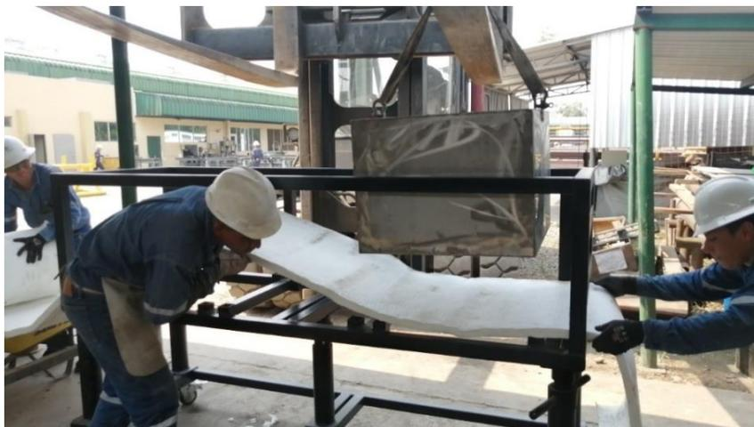
**Ilustración 3-48:** Montaje de las cámaras de calor en la estructura
