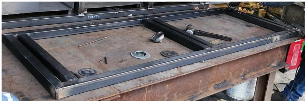
**Ilustración 3-24:** Base del horno antes del proceso de pintura
