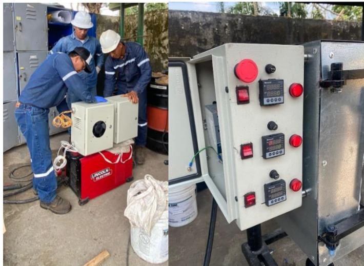
**Ilustración 3-52:** Montaje de los tableros eléctricos de control y potencia
